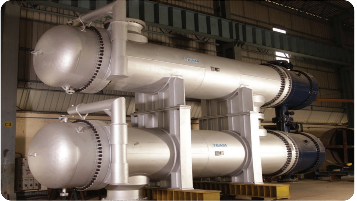
CLIENT : DORC EQPT. : HEAT EXCHANGER MOC : CS
